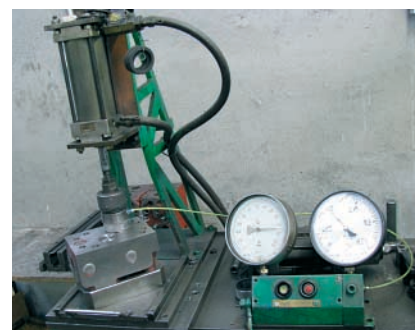
Aparatura do sprawdzania szczelności zaworów.
