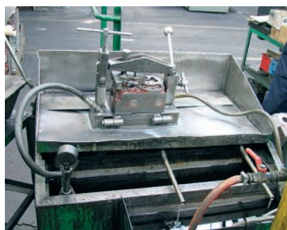
Proces sprawdzania szczelności płaszczki wodnego głowicy.
